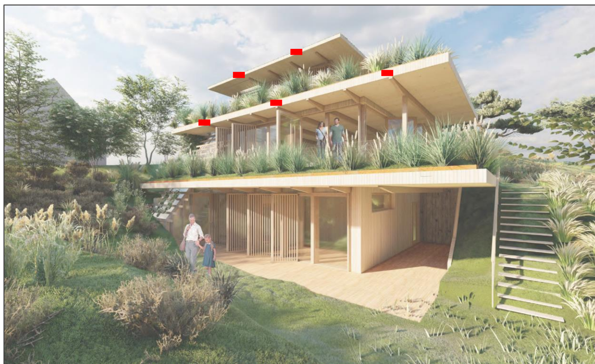
Afb 25: Locaties nestkasten of openingen in de dakranden ten gunste van huismussen of gierzwaluwen
