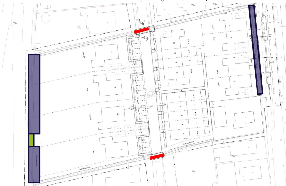
Afbeelding: locatie opwaarderen watergang/greppel (paars), bestaande dam (groen) en nieuwe duikers of bruggen (rood)
